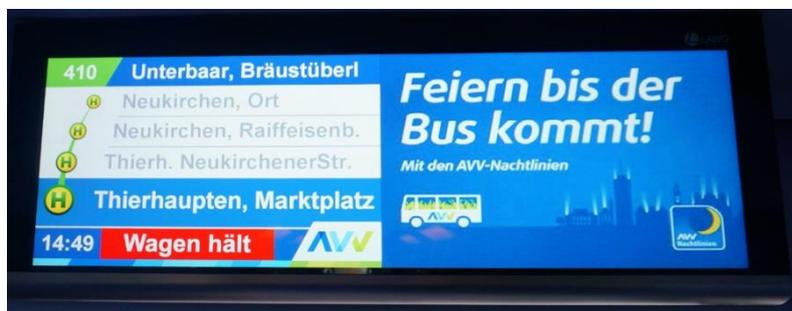
Dieser Bildschirm ist virtuell mittig zu teilen (siehe Bild oben). Die linke Hälfte ist für die oben gezeigte Darstellung zu reservieren. Diese Inhalte werden vom Fahrscheindrucker generiert. Die TFT-Monitore sind über Ethernet (mind. Cat 5e), mittels IBIS-IP (VDV 301), an den Fahrscheindrucker anzubinden. Die rechte Seite ist ausschließlich für AVV-
